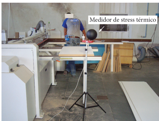
Figura 2. Medidor de stress térmico digital posicionado para medição.
