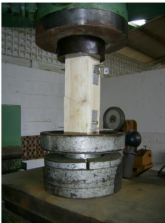
**Figura 2.** Corpo de prova após a ruptura.
