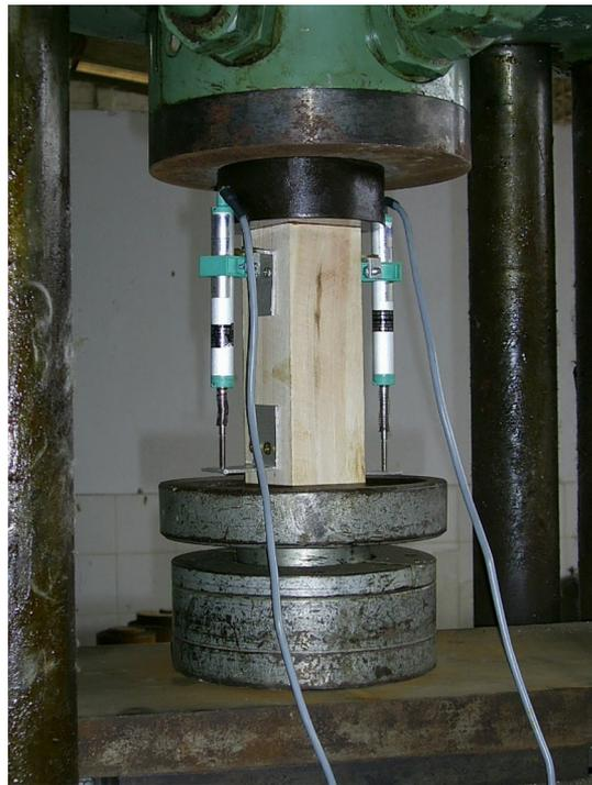
**Figura 1.** LVDTs nos lados do corpo de prova e detalhes do espaçador e da rótula.
