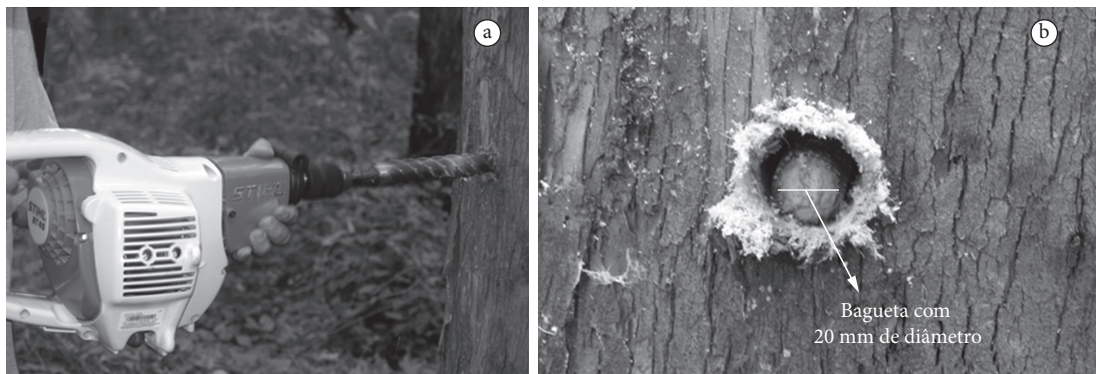
Figura 1. Método de amostragem não destrutivo utilizado para obtenção de baguetas de madeira de Eucalyptus pellita F. Muell. a) Trado adaptado ao perfurador STIHL® BT 45; e b) bagueta obtida pelo método não destrutivo. Figure 1. Nondestructive method used to obtain Eucalyptus pellita F. Muell wood samples. a) Increment core borer adapted to STIH® BT 45 perforator; and b) Increment core sampling.
