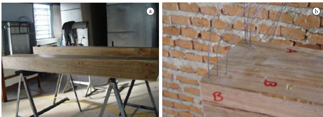
Figura 4. Vigas utilizadas na análise experimental: a) Preparação e marcação dos elementos; b) Fixação dos termopares. Fonte: Pinto (2005).
