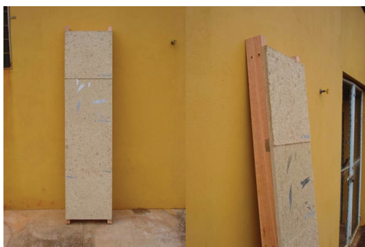
Figura 4. Ilustração do protótipo estrutural em madeira e painéis de partículas. Figure 4. Illustration of the structural prototype in wood and particleboards.
