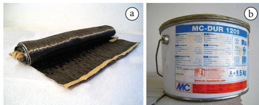
**Figura 1.** Fibra de carbono SikaWrap®-230C (a); Epoxi MC-DUR 1209 (b).
