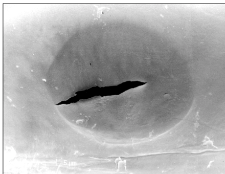
Figura 4. Rompimento da membrana de pontoação, observado em corte radial, no campo de cruzamento, após secagem à temperatura ambiente.
