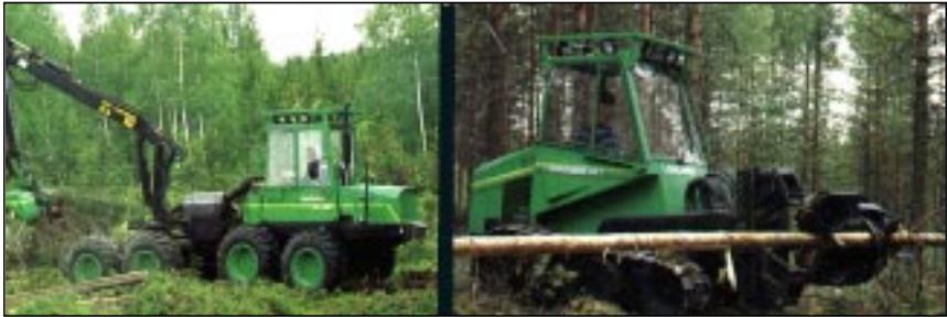
Figura 5. Conjunto motriz montado sobre rodas e sobre esteiras.
